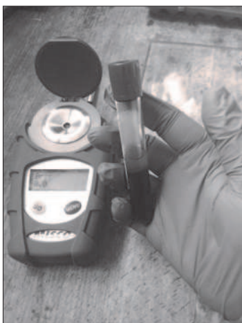
Рисунок 1. Исследование сыворотки крови телят. Цифровой рефрактометр Misco RA202x
