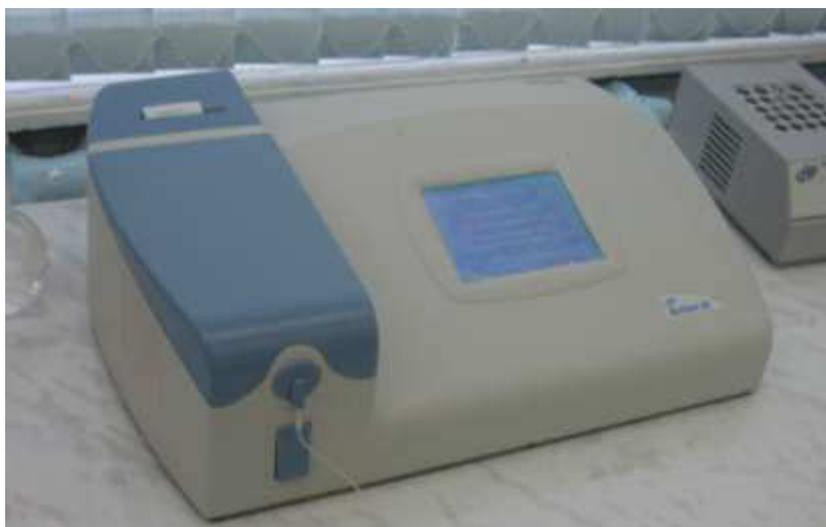
Рисунок 5 - Полуавтоматический биохимический анализатор BioChem SA.
