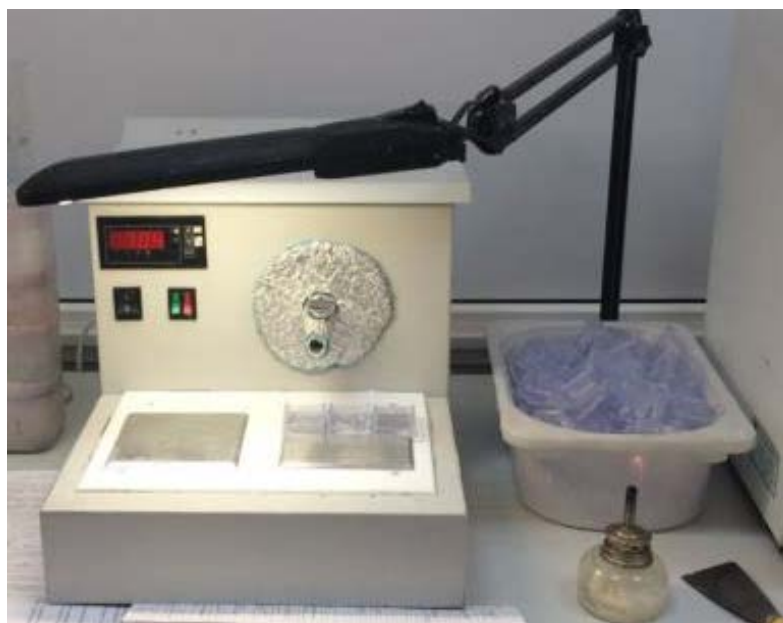
Рисунок 6 – Полуавтоматический диспенсер для заливки парафином.
