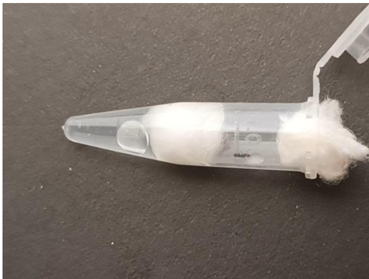
Рис.3. Биопроба. Заражение подопытных муравьёв per os путём кормления жидкой средой с конидиями Beauveria bassiana
